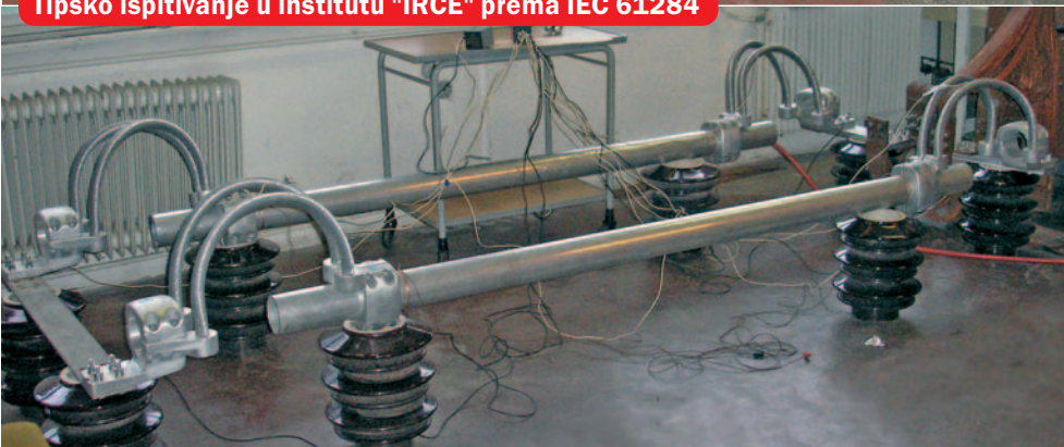
Tipsko ispitivanje u institutu "IRCE" prema IEC 61284
